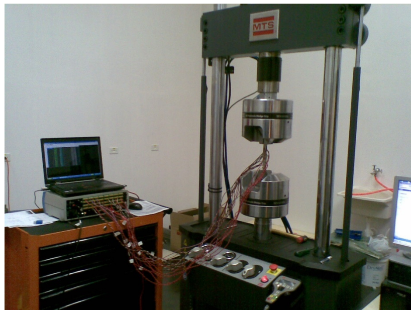
Fig. 37 Extensômetros conectados aos canais.
